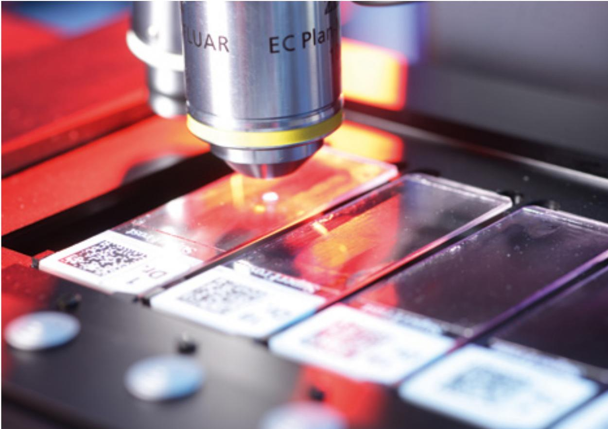
tion der Objektträger kann manuell oder maschinell erfolgen. Anschließend bearbeitet das Gerät selbstständig bis zu acht Proben in einem Durchgang. Es zoomt eine vorgegebene Anzahl an Leukozyten heran und erstellt hoch aufgelöste Aufnahmen von jeder gefundenen Zelle. Ein Programm sortiert die Zellen in verschiedene Gruppen. „Diese automatische Klassifizierung der Leukozyten war die größte Herausforderung“, sagt Christian Weigand.
