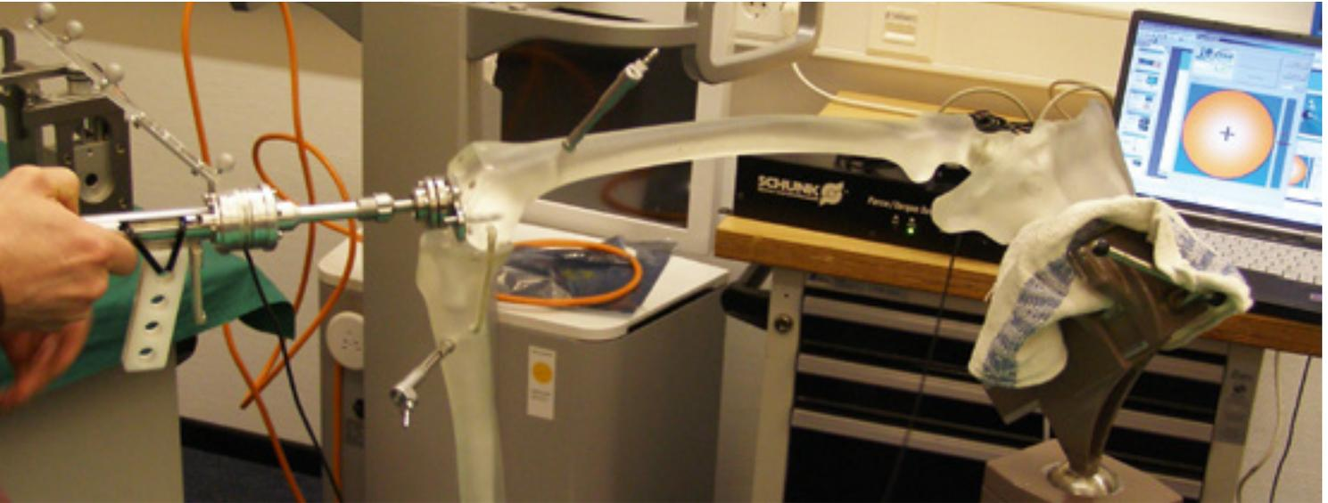
auf einem Monitor mithilfe eines Fadenkreuzes auf einer Zielschiebe beobachten, wie groß die Achsabweichung ist. Nimmt der Sensor eine gleichmäßige Belastung wahr, rückt das Fadenkreuz ins Zentrum. Dann hat der Arzt die exakte Beinachse getroffen. Mit dem Abzug fixiert er die Mündung am Knochen, um ihn anschließend im exakten 90-Grad-Winkel zur Belastungsrichtung zu schneiden. So kann er die Prothese achsgerecht an der Schnittfläche anbringen.
