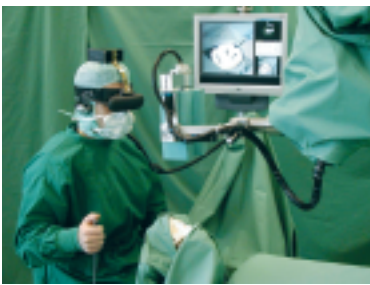
3D-Exoskop, Steuerungseinheit inklusive intuitiver Mensch-Maschine-Schnittstelle 3D-exoscope, control unit inclusive man-machine-interface
