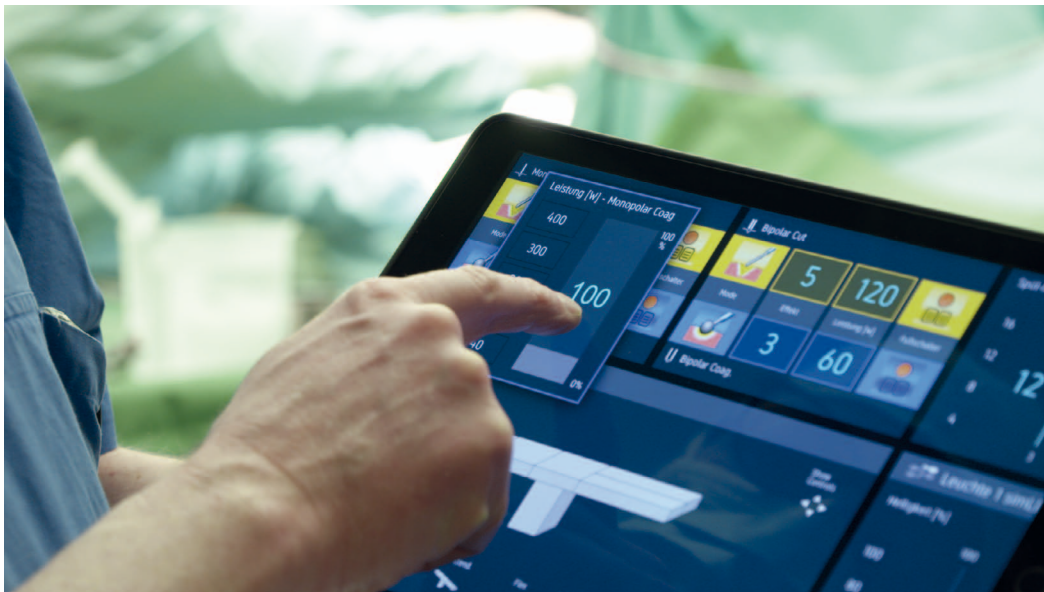
Leistungswahl für HF Generator über Tablet
