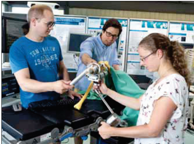
An einem Knochenmodell justiert Annegret Niesche den automatischen Fräskopf, der zukünftig bei Hüftoperationen eingesetzt werden soll.
